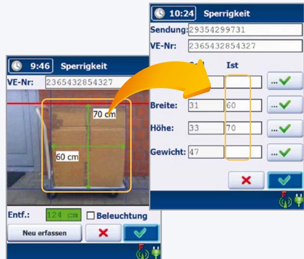
Abb.2: Messung und Datenübernahme der Ist-Werte in die Sperrigkeitserfassung
